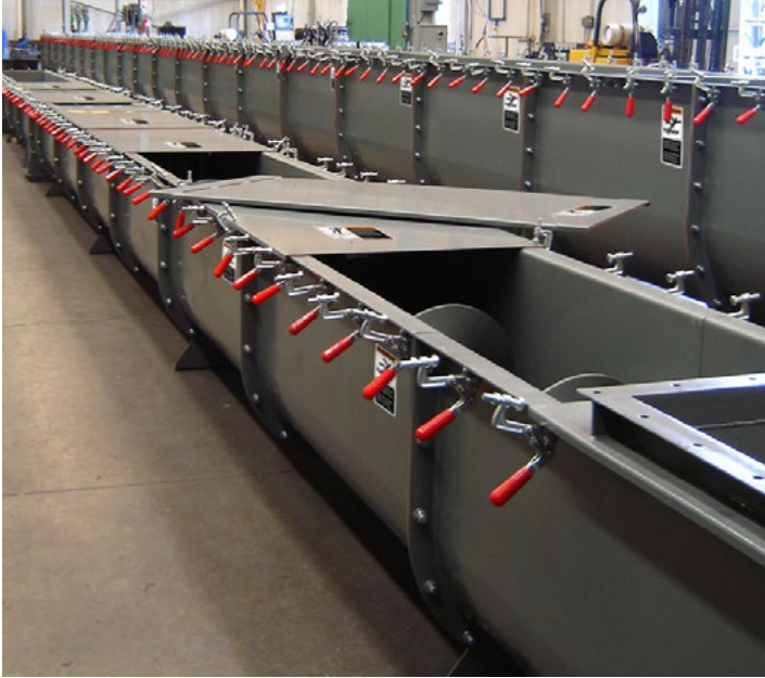
Las cubiertas se mantienen cerradas con prensas de lengüeta en la longitud total del transportador helicoidal.
