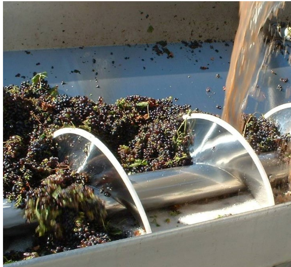
Transportador helicoidal de acero inoxidable grado alimenticio para procesamiento de vinos
