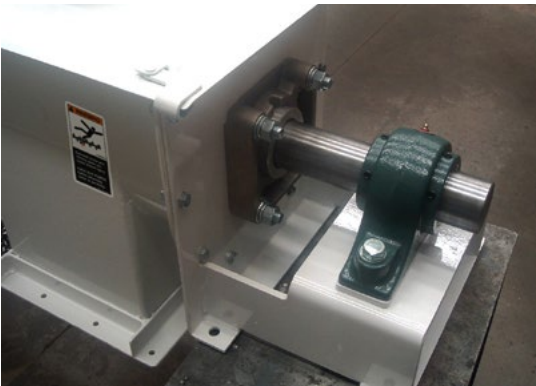
Sello en la tapa del transportador al que se le ha quitado la guarda únicamente para propósitos ilustrativos.
