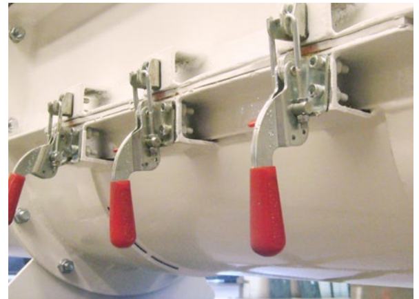
Las prensas de lengüeta mantienen cerrada una sección de la artesa de fondo desmontable que puede ser abierta para facilitar el mantenimiento, limpieza e inspección.
