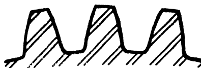
Paso Diametral 5 Paso Circular de 0.6283"
